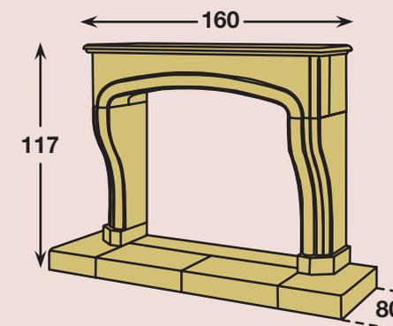
Ces modèles peuvent être réalisés en foyer ouvert avec différents habillages de briques réfractaires (joints clairs ou joints foncés), avec avaloir en acier muni d'un registre de fermeture. Dans le but de faire de votre cheminée un complément de chauffage, elle peut recevoir un foyer Thermi Confort avec porte escamotable et battante.
