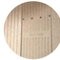
Corps de chauffe en vermiculite structurée
