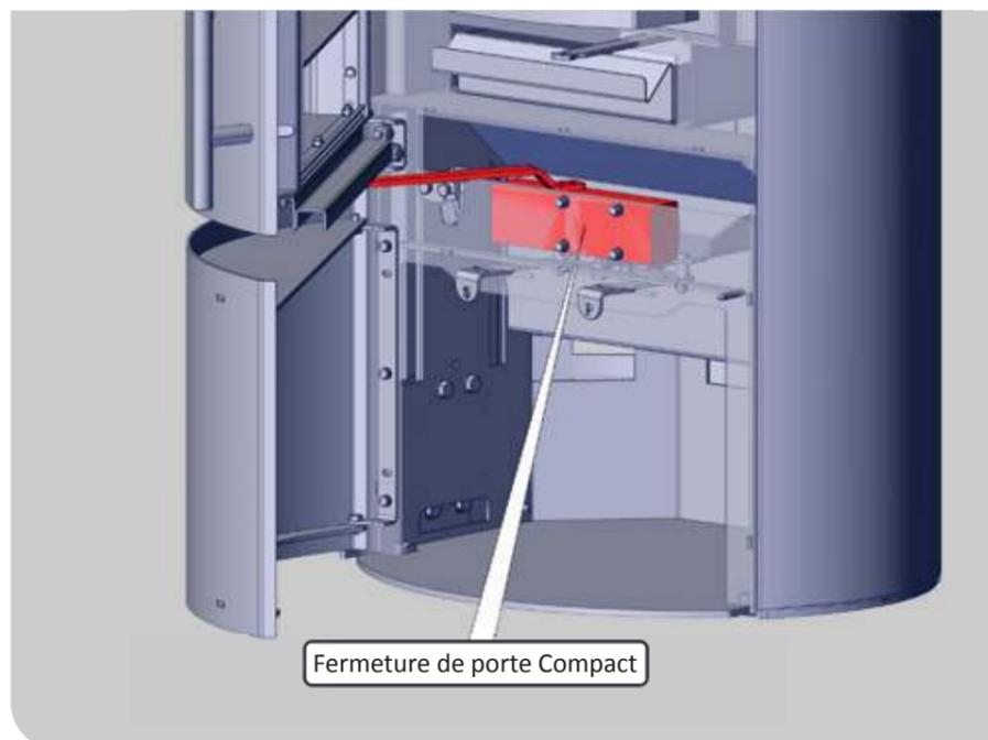
Les poêles équipés du système de fermeture Compact disposent d'un agrément technique, aussi bien pour un fonctionnement dépendant de l'air ambiant que pour un fonctionnement indépendant de l'air ambiant. En cas de montage avec un système de ventilation homologué, aucun dispositif de sécurité supplémentaire n'est nécessaire en cas de fonctionnement indépendant de l'air ambiant.
