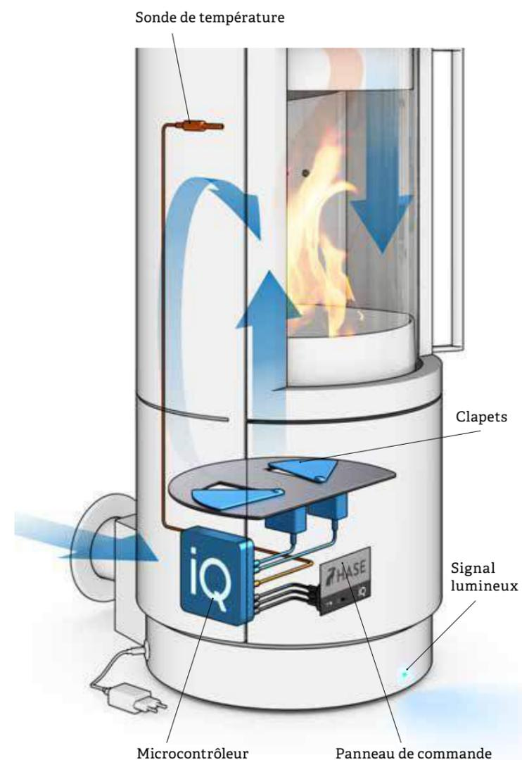
Les débits d'air sont ainsi ajustés et l'application iQ permet de suivre la qualité de la combustion du feu à la seconde près.
